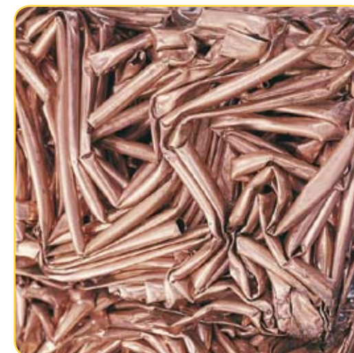
Figura 1.7. Chatarra del proceso productivo, compactada para ser introducida en el horno
