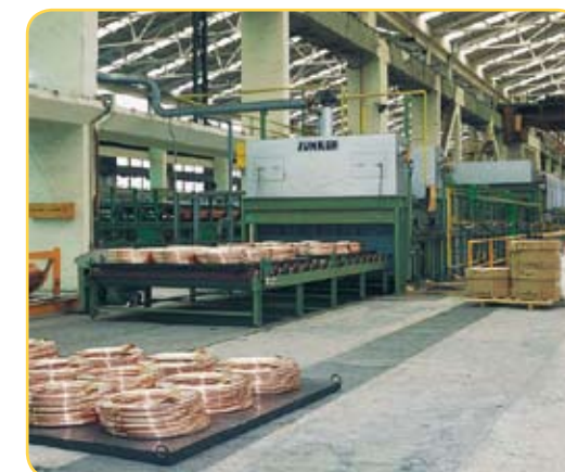
Figura 1.13. Tratamiento térmico de los tubos para obtención del estado recocido
