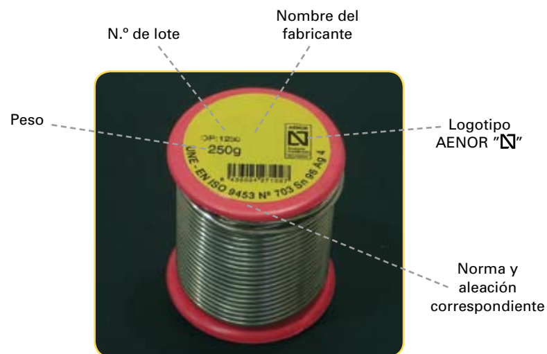
Figura 2.25. Carrete metal aporte con licencia de marca de calidad AENOR. Identificación de la aleación
