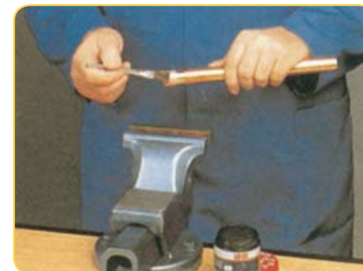
Figura 3.12. Aplicación del decapante
