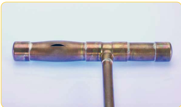
Figura A.1. Dimensión 22 x 1 mm. Rotura a 280 bar. Soldadura blanda (prueba efectuada incrementando la presión hasta la rotura del tubo)
